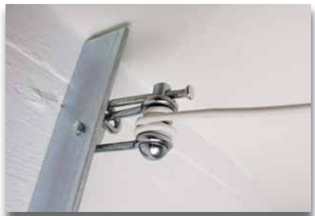
Nachspannen der Wäscheleine mit dem Drahtseilspanner.
